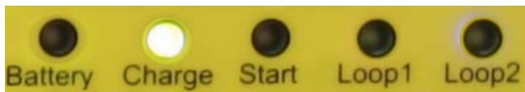
Lysdioden merket 'Battery' indikerer hvor mye batterikapasitet enheten har igjen. Rødt lys betyr at batterikapasiteten er under 30%. Oransje 30-60%. Gult 60-90%. Grønt lys betyr at batterikapasiteten er over 90%. Hvis ESD2 er fulladet, skal den ved normalt bruk ha batterikapasitet til ca. 10-12 timers drift.
