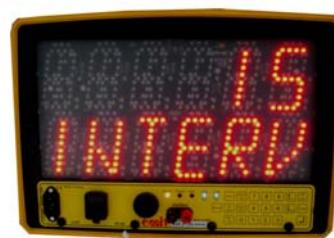
Til slutt ønsker vi å stille starttiden; altså tidspunktet FØR første start i arrangementet. Vi trykker «EDIT» tasten en gang og displayet viser «10:00:00» på øverste linje («gammel» starttid), og «START» på nederste linje. Tast inn ønsket tid (HH:MM:SS) med de numeriske tastene og avslutt med «ENTER». Hvis man taster feil kan man slette forrige tegn ved å trykke «CLEAR».
