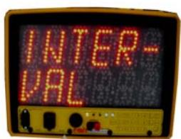
Løpende tid (hh:mm:ss) vises på øverste linje, startnr. og nedtelling av sekunder vises på nederste linje. Bruker starttiden og startintervallet som er lagt inn manuelt for å beregne startnr. NB! Startnr. 1 starter alltid på starttiden til arrangementet **PLUS** ett intervall (f.eks. 10:00:00 + 15 sek = 10:00:15)
